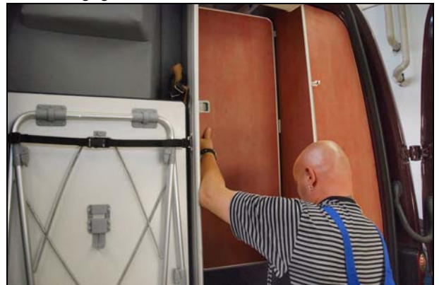
Abb.: oberes und unteres Band losschrauben
