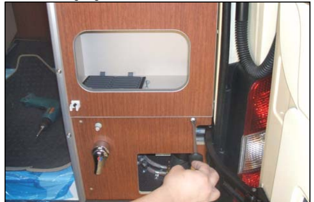
Abb.: Schläuche und Anschluss für Außendusche lösen
