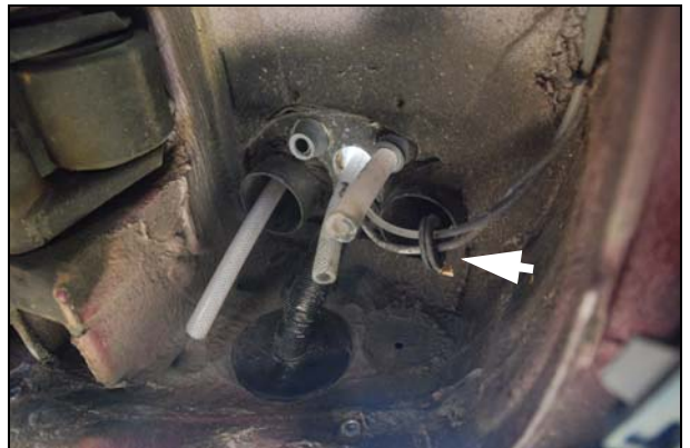
Abb.: einwandfreie Durchführungen am Wagenboden
