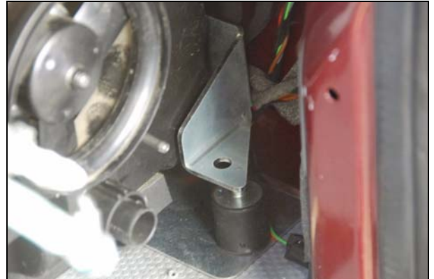
Abb.: rechte Seite mit Keil herunter drücken
