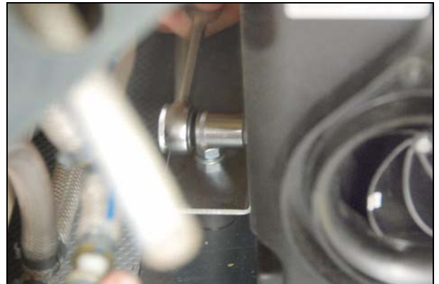
Abb.: Muttern (mit Unterlegscheiben) festschrauben
