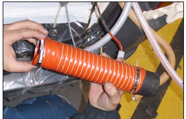
Abb.: Schlauchschelle überschieben
