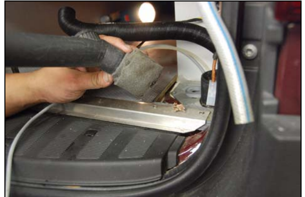
Abb.: Dichtwand aufklebern
