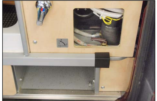
Abb.: Funktion der Ablasshähne überprüfen
