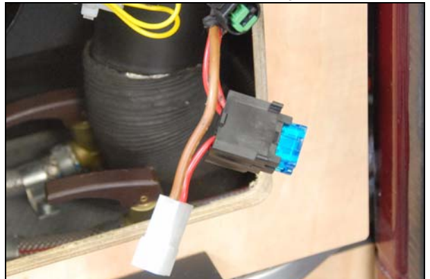
Abb.: Steckverbindung zusammenstellen
