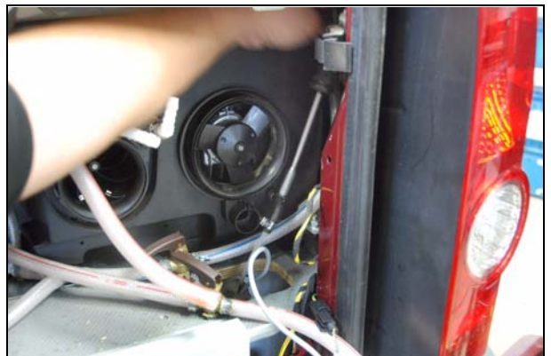
Abb.: Schelle festziehen
