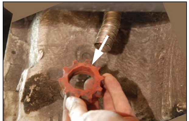
Abb.: entfernte Quetschmuffe
