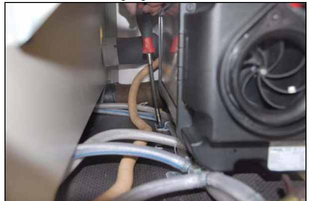
Abb.: dünnes Heizungsrohr abnehmen
