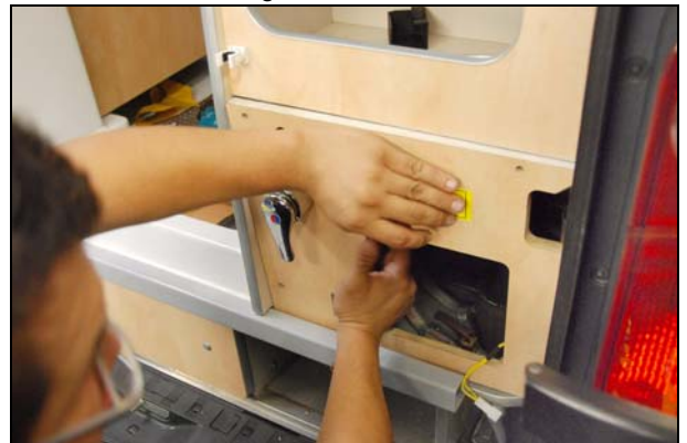
Abb.: Heckverkleidung festschrauben
