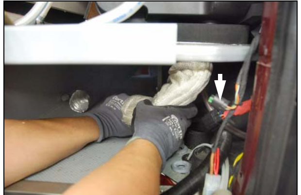
Abb.: Abgasschlauch von der Heizung ziehen
