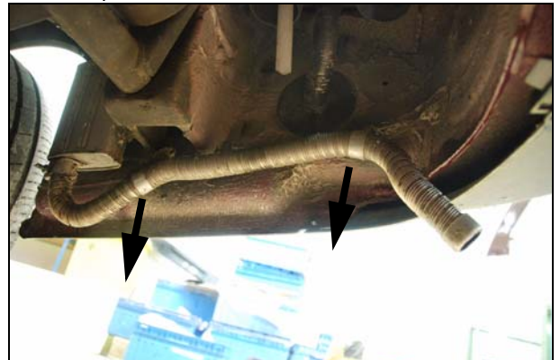
Abb.: Auspuffstück kürzen
