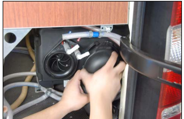
Abb.: Schlauch samt Kappe nach oben herausziehen
