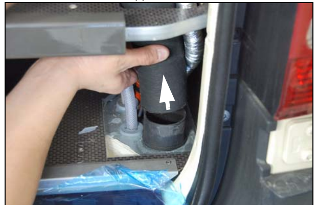
Abb.: Schlauch samt Adapter abziehen
