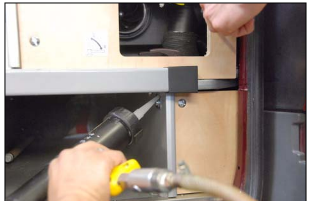
Abb.: Dichtmasse an der Unterkante
