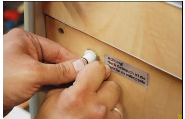
Abb.: Sicherungsring mit Schraubenzieher einschieben
