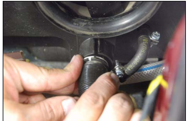
Abb.: ganz eingesteckter Schlauch
