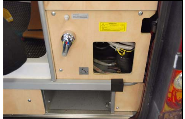
Abb.: Trennwand oben und unten abdichten
