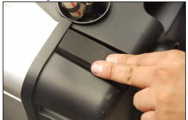
Abb.: Dichtungsstück einkleben
