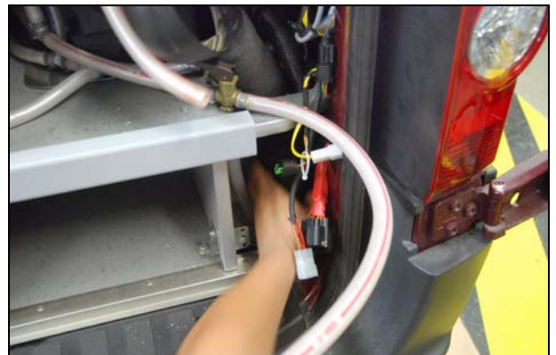
Abb.: unteres Schlauchende auf den Stutzen stecken
