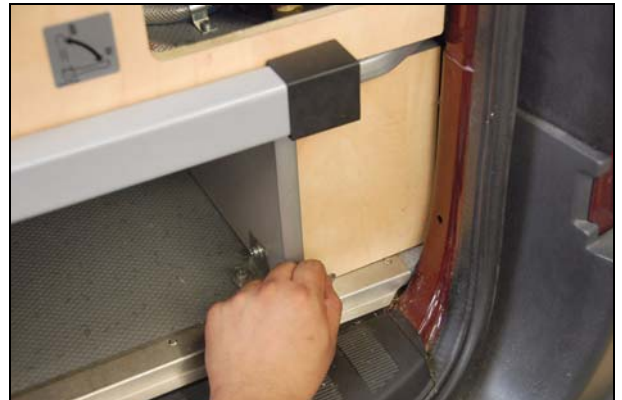
Abb.: kleine Verkleidungsplatte festschrauben
