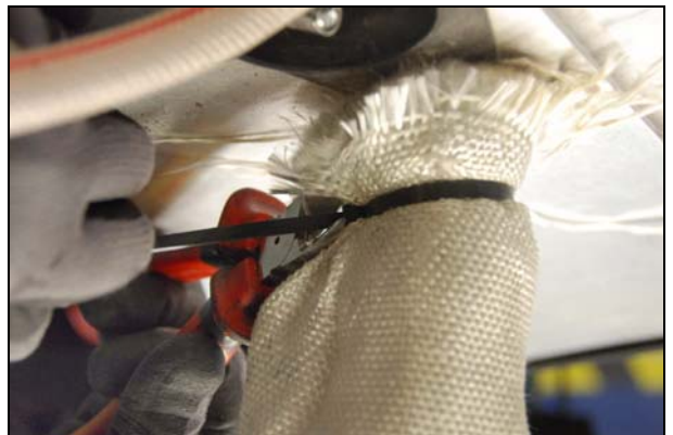
Abb.: Kabelbinderrest abknipfen
