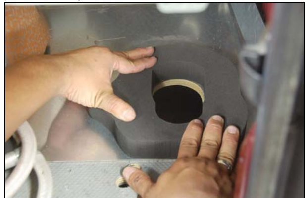
Abb.: Dichtungsstück einkleben
