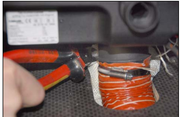
Abb.: untere Schlauchschelle lösen
