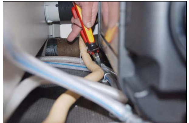
Abb.: Schlauchbefestigungen entfernen
