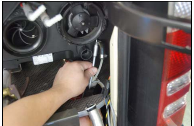
Abb.: Dieselleitung abziehen
