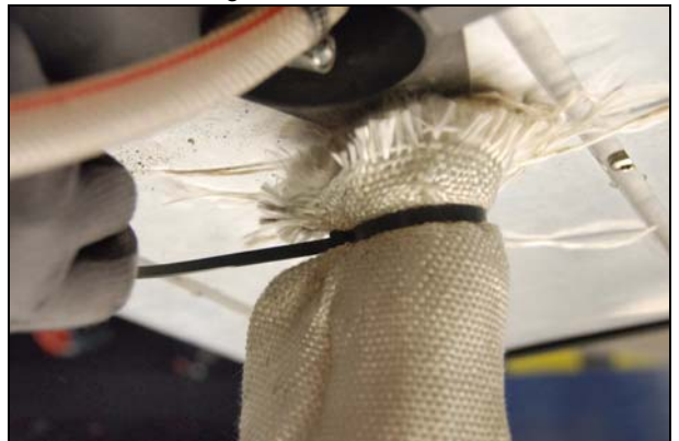
Abb.: Kabelbinderrest abknipfen
