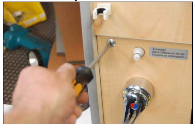
Abb.: Heckverkleidung festschrauben
