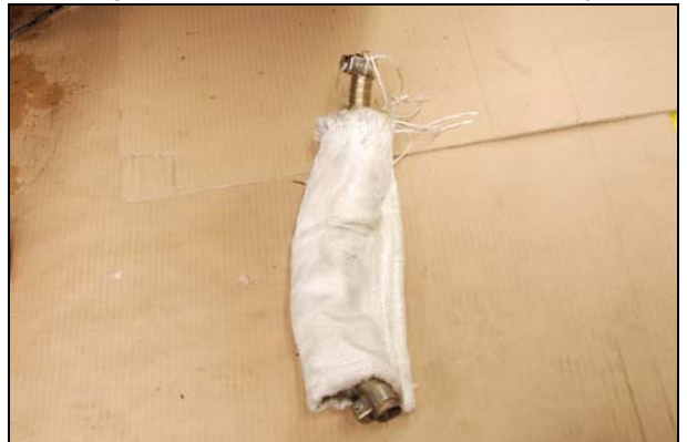
Abb.: Abgasschlauch mit Schellen und Umhüllung
