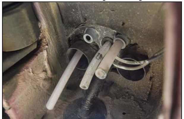
Abb.: einwandfreie Durchführungen am Wagenboden
