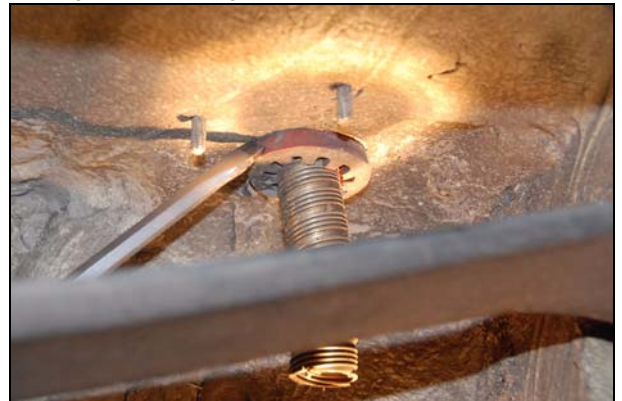
Abb.: Katalysator einstecken und Schelle festziehen
