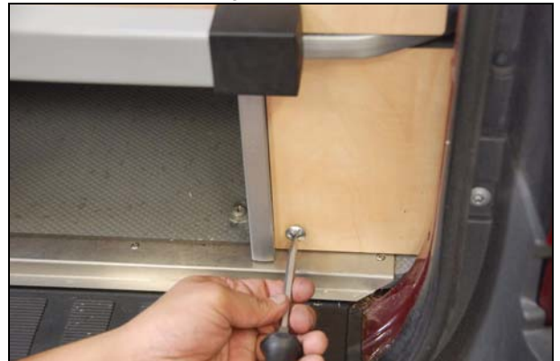
Abb.: Heckverkleidung schließen
