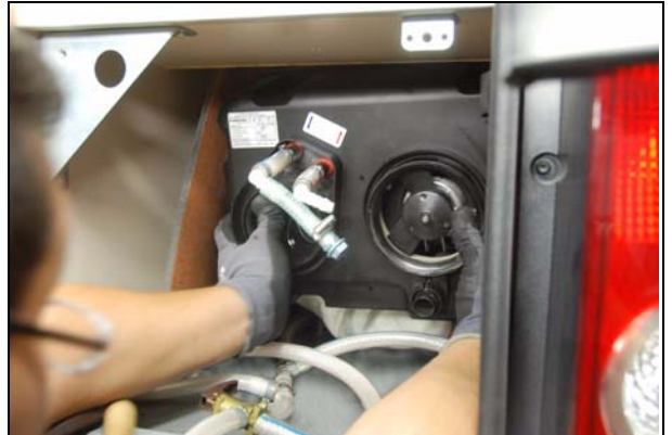
Abb.: dabei das Vorderteil der Heizung angeben
