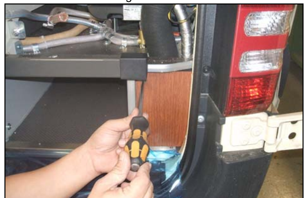
Abb.: kleine Verkleidung und Winkel entfernen
