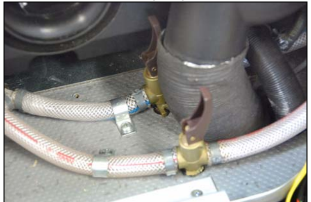
Abb.: alle Kabel und Schläuche durch Muffen führen
