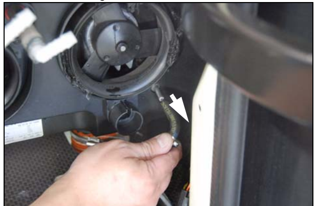
Abb.: bei vorhandenem Restwasser Anschlüsse verschließen
