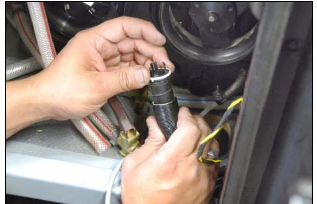
Abb.: Adapter mit der Nase in der Nut einstecken
