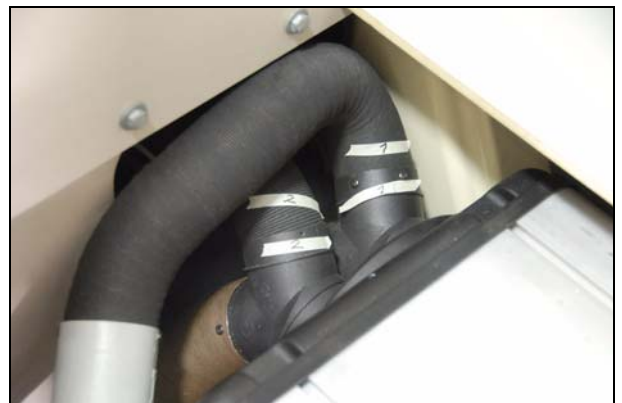
Abb.: Markierung für spätere Zuordnung bei der Montage
