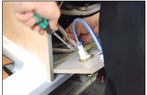
Abb.: Kaltwasserschlauch anschließen
