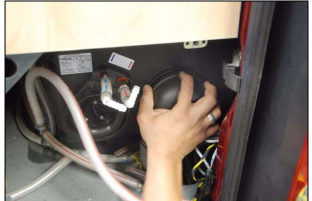
Abb.: Sicherungsschraube einschrauben
