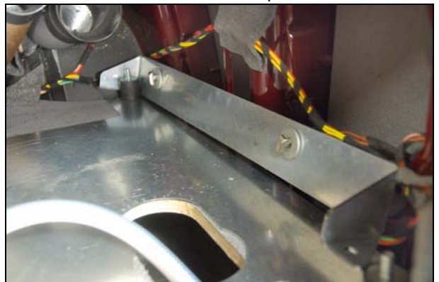
Abb.: rechter Halter mit Hammerkopfschrauben
