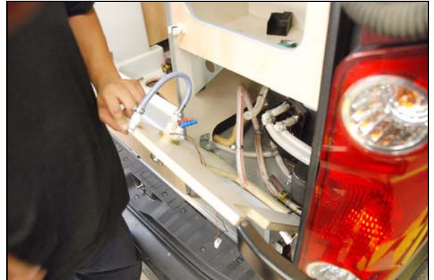
Abb.: Warmwasserschlauch anschließen
