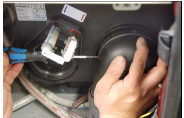
Abb.: Brauchwasserleitungen befestigen
