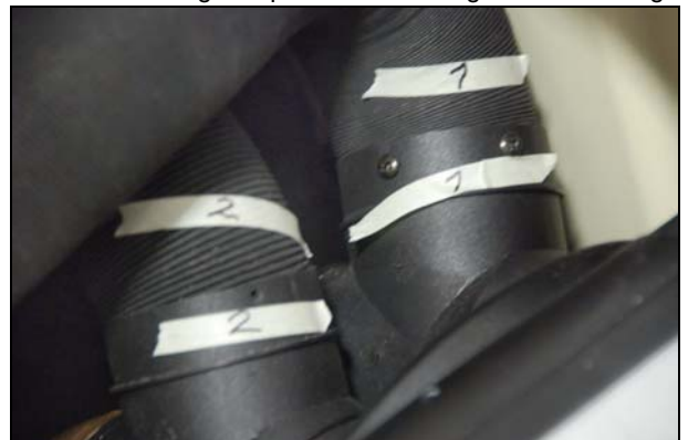
Abb.: Markierung für spätere Zuordnung bei der Montage
