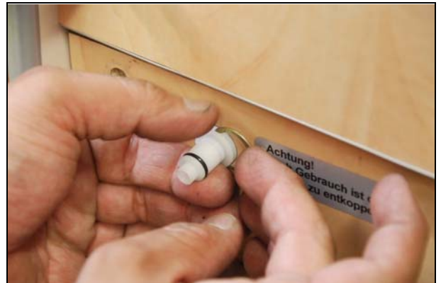
Abb.: Sicherungsring mit Schraubenzieher einschieben
