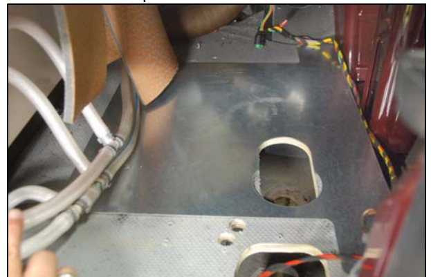
Abb.: Bodenblech positionieren
