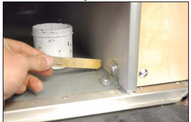
Abb.: Dichtmasse mit Abglättmittel abziehen
