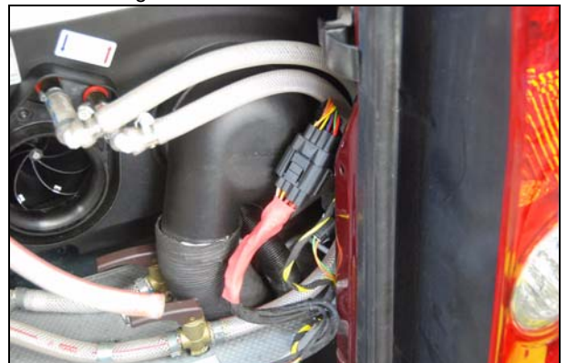
Abb.: Führung der beiden Brauchwasserschläuche
