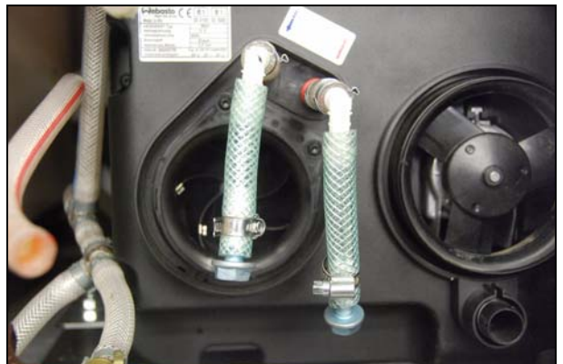
Abb.: bei vorhandenem Restwasser Anschlüsse verschließen
