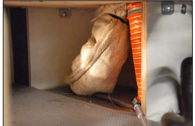
Abb.: unteres Ende mit Schelle sichern
