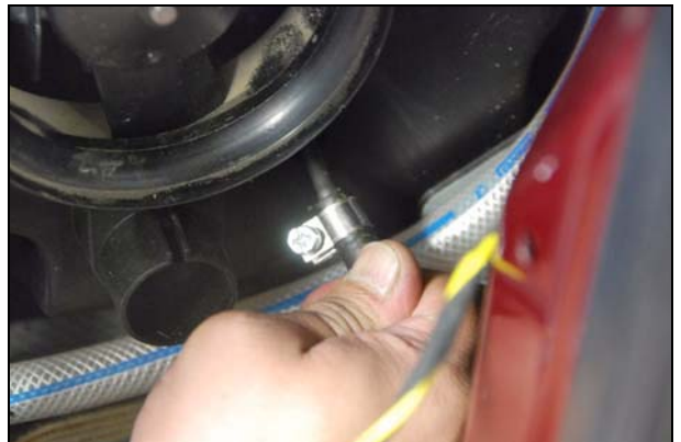
Abb.: Schelle festziehen
