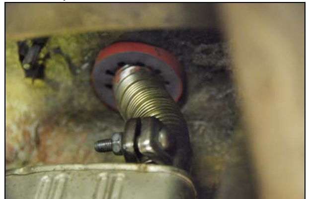
Abb.: Katalysator befestigen
