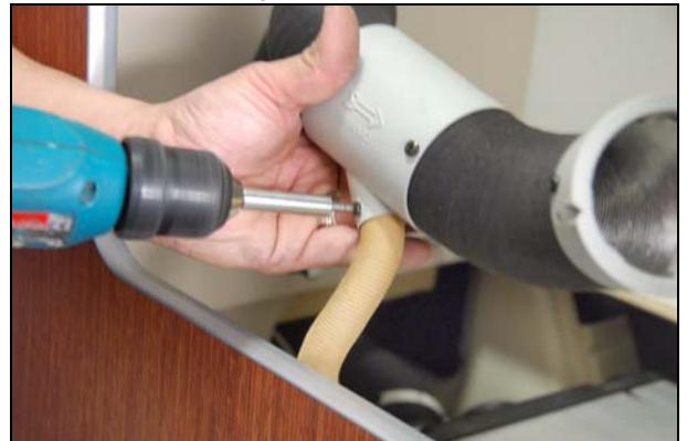
Abb.: dünnes Heizungsrohr abnehmen
