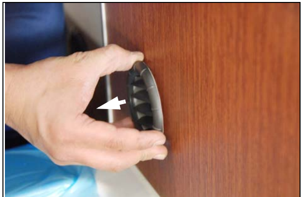
Abb.: Ausströmer abschrauben
