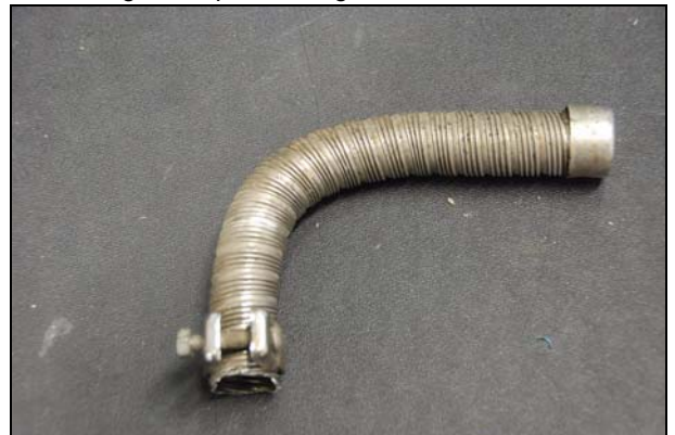
Abb.: Auspuffende mit dem Winkel befestigen
