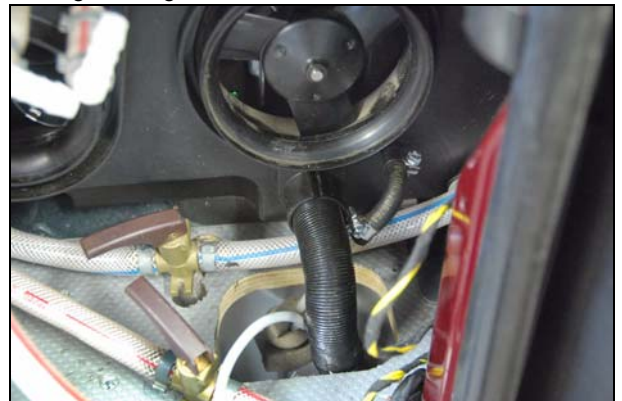
Abb.: unteres Schlauchende auf den Stutzen stecken
