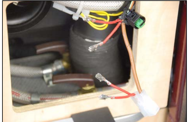
Abb.: Flachstecker und 15-A-Sicherungen einstecken
