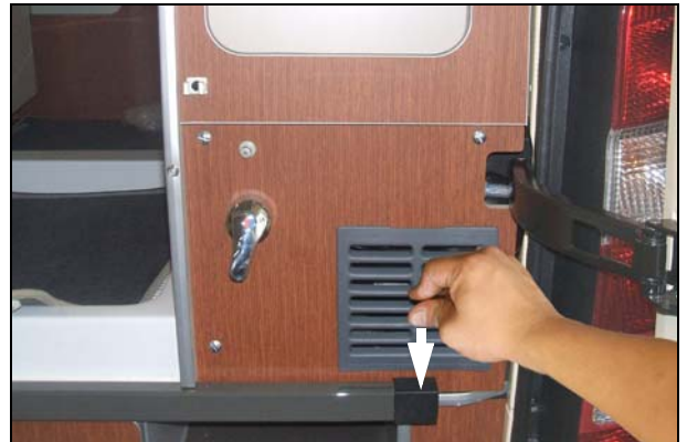
Abb.: Befestigungsschrauben entfernen
