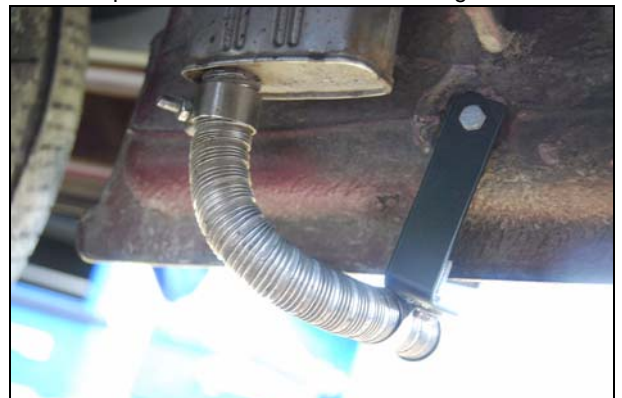
Abb.: Auspuffende mit dem Winkel befestigen
