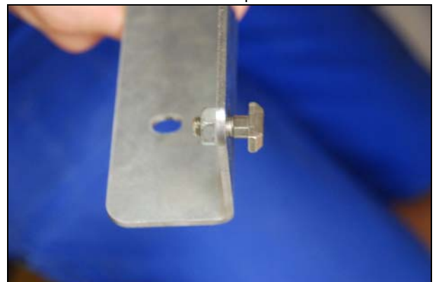
Abb.: Schraubenköpfe in die Nut einsetzen
