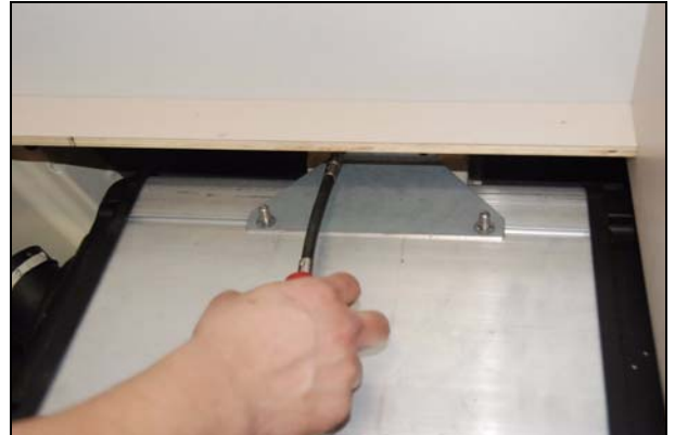
Abb.: obere Halterung abnehmen
