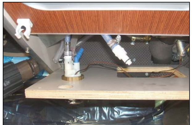
Abb.: kleine Verkleidung und Winkel entfernen
